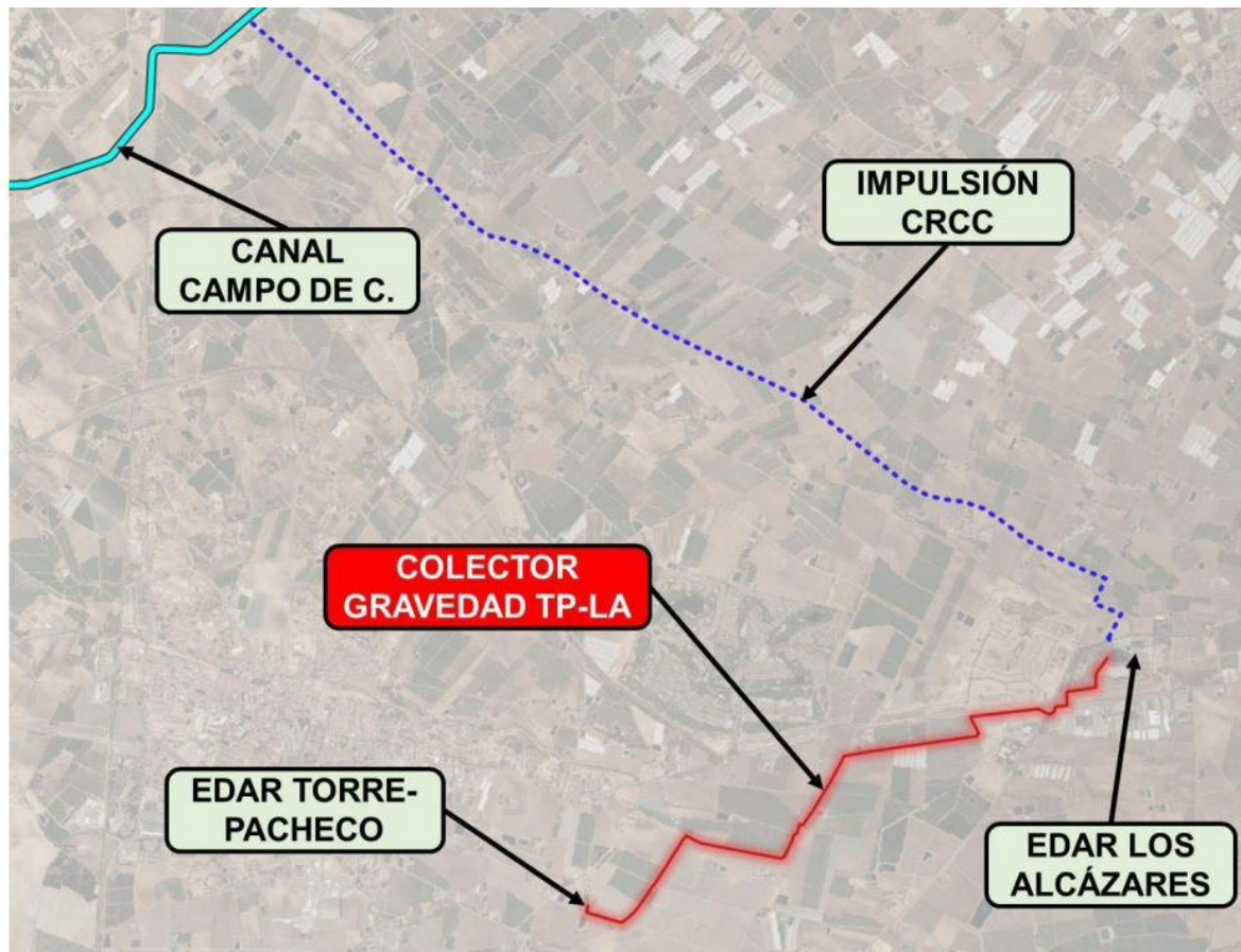
Figura 20. Esquema del proyecto de conexión por gravedad desde la EDAR de Torre Pacheco hasta la EDAR de Los Alcázares.
